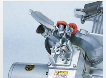
砥石部は研磨時のみのアタッチメント方式で衛生的。
