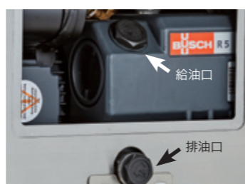
3 排油口からオイルを拭き取ったら、ネジをしっかりと締め付けてください。
