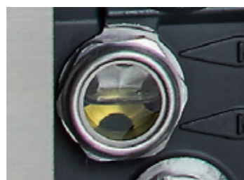
5 注入するオイルの量は、オイルゲージで確認し、適量を注入してください。
