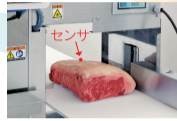
材料の形状を上下2個ずつの変位センサにより読み込み、自動でスライス開始。
