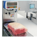
材料の重量測定完了後、肉送りベルトに載せ替えてスタートスイッチを押すだけ。
