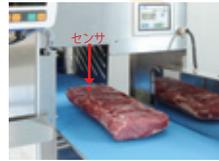
材料の形状を上下2個ずつの変位センサにより読み込み、自動でスライス開始。
