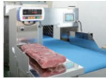
材料の重量測定完了後、肉送りベルトに載せ替えてスタートスイッチを押すだけ。
