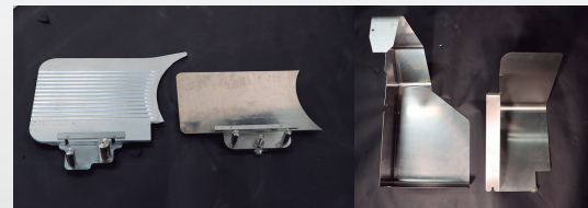
一般的なシンクで洗浄しやすい部品設計(※5) *左:旧 右:新
