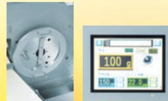
丸刃脱着安全カバー 簡単操作の液晶タッチパネル
