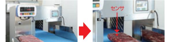
材料の重量測定完了後、肉送りベルトに載せ替えてスタートスイッチを押すだけ。
