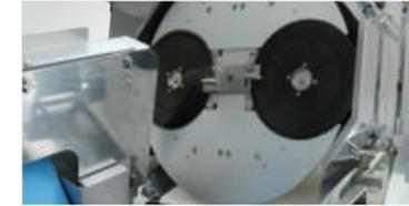
丸刃の材質や刃先、形状など研究を重ねることで優れた切れ味・歩留まり性能を実現することができました。また、二枚刃構造にすることで少ない回転数での大量処理を可能にしました。また丸刃周りのカバーとシューターで屑の飛散を防ぎコンベヤ上に落とします。
