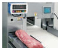
材料の重量測定完了後、肉送りベルトに載せ替えてスタートスイッチを押すだけ。
