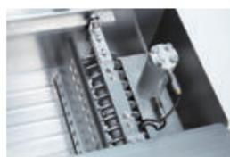
ツメ部が自動のエアチャッキングになっているので、省力化で作業効率がアップします。
