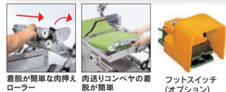
着脱が簡単な肉押しローラー 肉送りコンベヤの着脱が簡単 フットスイッチ (オプション)
