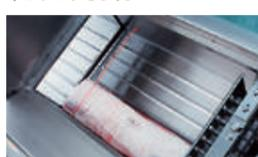
ツメ部で肉をホールドした後、頭出しセンサによって、自動的にスライス開始の先端部まで送り込みます。
