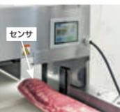
材料の形状を上下2箇所ずつの変位センサにより読み込み、自動でスライス開始。
