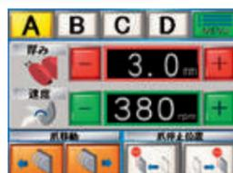
5.7インチのカラー液晶タッチパネルは、見やすく操作も簡単。厚み設定やスライス速度など、誰でも容易に作業設定が出来ます。
