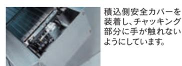
積込側安全カバーを装着し、チャッキング部分に手が触れないようにしています。
