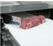
エンドロス排出で歩留まり、作業効率アップ ※エンドロス排出とは、最後の不定形部分をスライスせずに排出すること。
