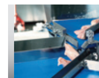
二段階の脱水コンベヤで原料裏表のドリップが自動で除去されます。
