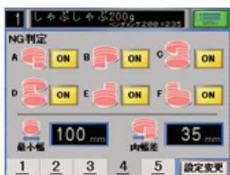
NG品運動状態 NG判定するスライスブロックの形状を任意に設定可能。NGブロックは盛付けずそのまま排出。最大800パック/時 ※130g 7枚時想定（※厚み、肉質により異なります。）作業者の技量を問わず安定した生産量を見込めます。
