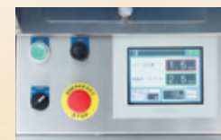
設定はエアの注入量と底板のオープントイムのみ。袋の種類によって複数パターン登録可能。間欠運転も可能です。
