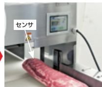
材料の形状を上下2個ずつの変位センサにより読み込み、自動でスライス開始。
