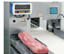
材料の重量測定完了後、肉送りベルトに載せ替えてスタートスイッチを押すだけ。
