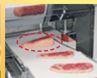
エンドロス排出で歩留まり、 作業効率アップ ※エンドロス排出とは、最後の不定 形な部分をスライスせずに排出す ること。
