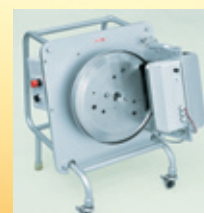
専用研磨装置で半自動研磨 が可能
