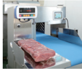
材料の重量測定完了後、肉送りベルトに載せ替えてスタートスイッチを押すだけ。
