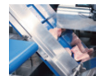
原料をコンベヤで引き上げ、脱水コンベヤに自動で投入されます。
