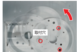
丸刃偏芯軌道 丸刃に取付穴が3箇所あり、取付位置を変更することで通常の3倍使用可能。
