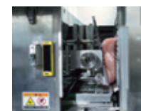
クランプ板で挟み込み、クリーンエアを注入、ステンレス鋼のカッターで一発カット。
