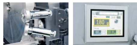
丸刃の切れ味を保つ砥石部。 簡単操作の液晶タッチパネル。
