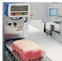
材料の重量測定完了後、肉送りベルトに載せ替えてスタートスイッチを押すだけ。
