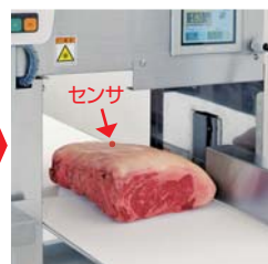
材料の形状を上下2個ずつの変位センサにより読み込み、自動でスライス開始。
