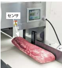
材料の形状を上下2箇ずつの変位センサにより読み込み、自動でスライス開始。
