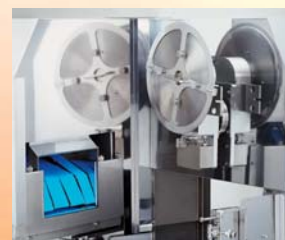
大きく開く肉箱周辺部。清掃時も安心の丸刃安全カバーは標準装備。
