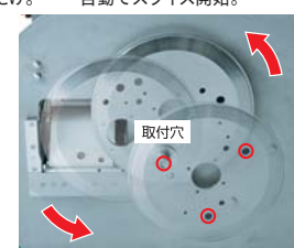
丸刃偏芯軌道 丸刃に取付穴が3箇所あり、取付位置を変更することで通常の3倍使用可能。
