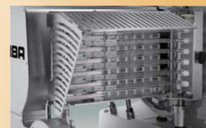
チェーンフレームにカバーが付いており、より 安全に作業が出来るようになりました。
