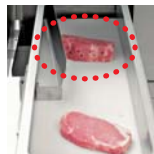
エンドロス排出で歩留まり、作業効率アップ ※エンドロス排出とは、最後の不定形部分をスライスせずに排出すること。排出された部分は他の商品原料にできる。
