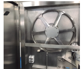
自動調整刀鋸條的張力, 並具有負載檢測功能
