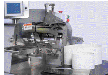
コンベアベルトも工具なしで脱着できます。
