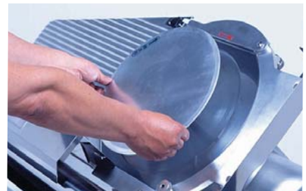
特に丸刃周りは外周カバー・中カバーが工具なしで簡単に脱着できてラクに洗浄掃除がおこなえます。
