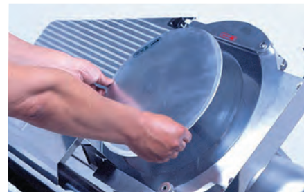
特に丸刃周りは外周カバー・中カバーが簡単に脱着できてラクに洗浄掃除がおこなえます。
