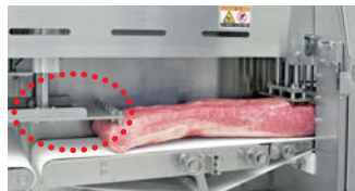
冷凍食材をしっかりホールドするチャッキング
