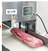
材料の形状を上下2箇ずつの変位センサにより読み込み、自動でスライス開始。
