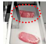
エンドロス排出で歩留まり、作業効率アップ ※エンドロス排出とは、最後の不定形部分をスライスせずに排出すること。排出された部分は他の商品原料にできる。
