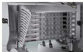
チェンフレームにカバーが付いており、より 安全に作業が出来るようになりました。
