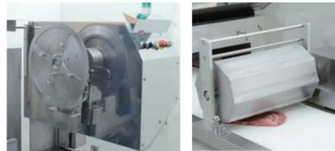
大きく開く肉箱周辺部。清掃時も安心の丸刃安全カバーは標準装備。カール抑制装置
