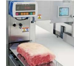
材料の重量測定完了後、肉送りベルトに載せ替えてスタートスイッチを押すだけ。
