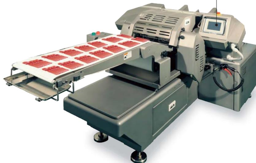
プラス温度帯の背ロース、肩ロース、モモなどをスライスし、二つ折してコンベヤ上に整列させます。
