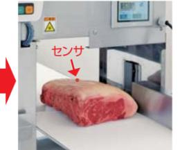
材料の形状を上下2個ずつの変位センサにより読み込み、自動でスライス開始。
