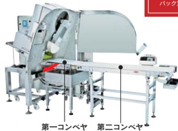
中は凹凸のないフラットな面、また、第一コンベヤを簡単に移動することができるため、清掃も簡単に衛生的です。
