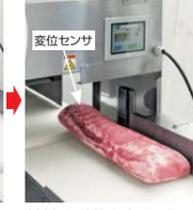
材料の形状を上下2つつつの変位センサにより読み込み、自動でスライス開始。
