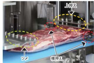
上押え・横押え・ツメの合計4箇所で大口径原木もしっかりホルド。
