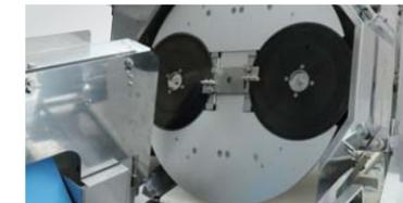
丸刃の材質や刃先、形状など研究を重ねることで優れた切れ味・歩留り性能を実現することができました。また、二枚刃構造にすることで少ない回転数での大量処理を可能にしました。また丸刃周りのカバーとシューターで屑の飛散を防ぎコンベヤ上に落とします。
